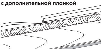
Поперечный шов – простой фальц с дополнительной планкой
