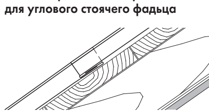
Фальц в фальц – поперечный шов для углового стоячего фальца
