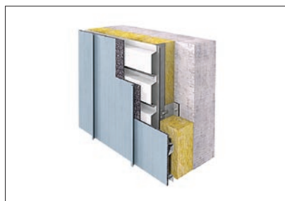
Вентилируемая подконструкция 2 из металла
